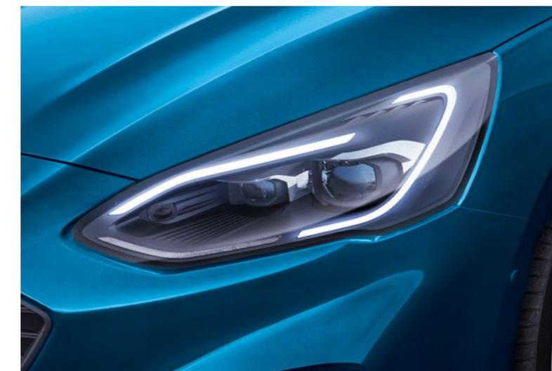
**Intelligente LED-Scheinwerfer mit blendfreiem Fernlicht-Assistenten und kamerabasiertem Kurvenlicht**
