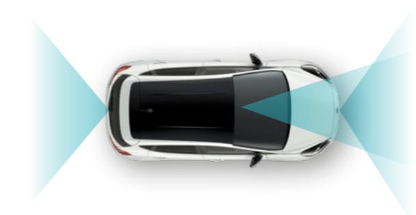
**Optische Sensoren** (Kameras) sind in der Front bzw. am Heck des Fahrzeugs positioniert und steuern folgende Assistenzsysteme:
