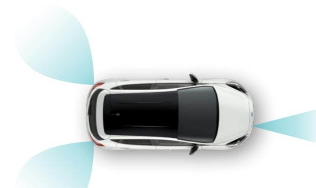
**Radarsensoren** für die adaptive Geschwindigkeitsregelanlage und für den Toter-Winkel-Assistenten befinden sich im Frontgrill sowie seitlich im hinteren Stoßfänger.
